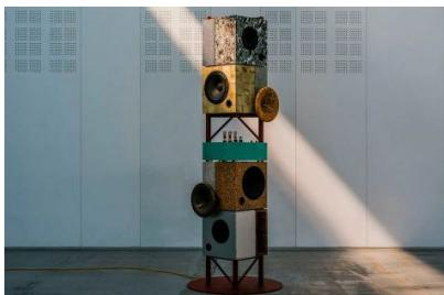
乃村工芸社グループでは2022年度より技術・研究開発によって社会課題にアプローチするR&D活動に取り組んでいます。その活動の一環として、“素材＝地球資源”をテーマとした「material record（マテリアルレコード）」を乃村工芸社と共同で立ち上げ、大量の資源を消費する建築・内装業界において、素材を起点にサステナブルな研究・開発を行っています。音響装置「noon by material record（ヌーン バイ マテリアルレコード）」はそのプロジェクトの第一弾。建築廃材、海岸に漂着したプラスチック片、デニム端材など、サステナブル・マテリアルを活用してスピーカーを制作し、音響体験を通して素材の新しい価値観を生み出すことにチャレンジしています。
